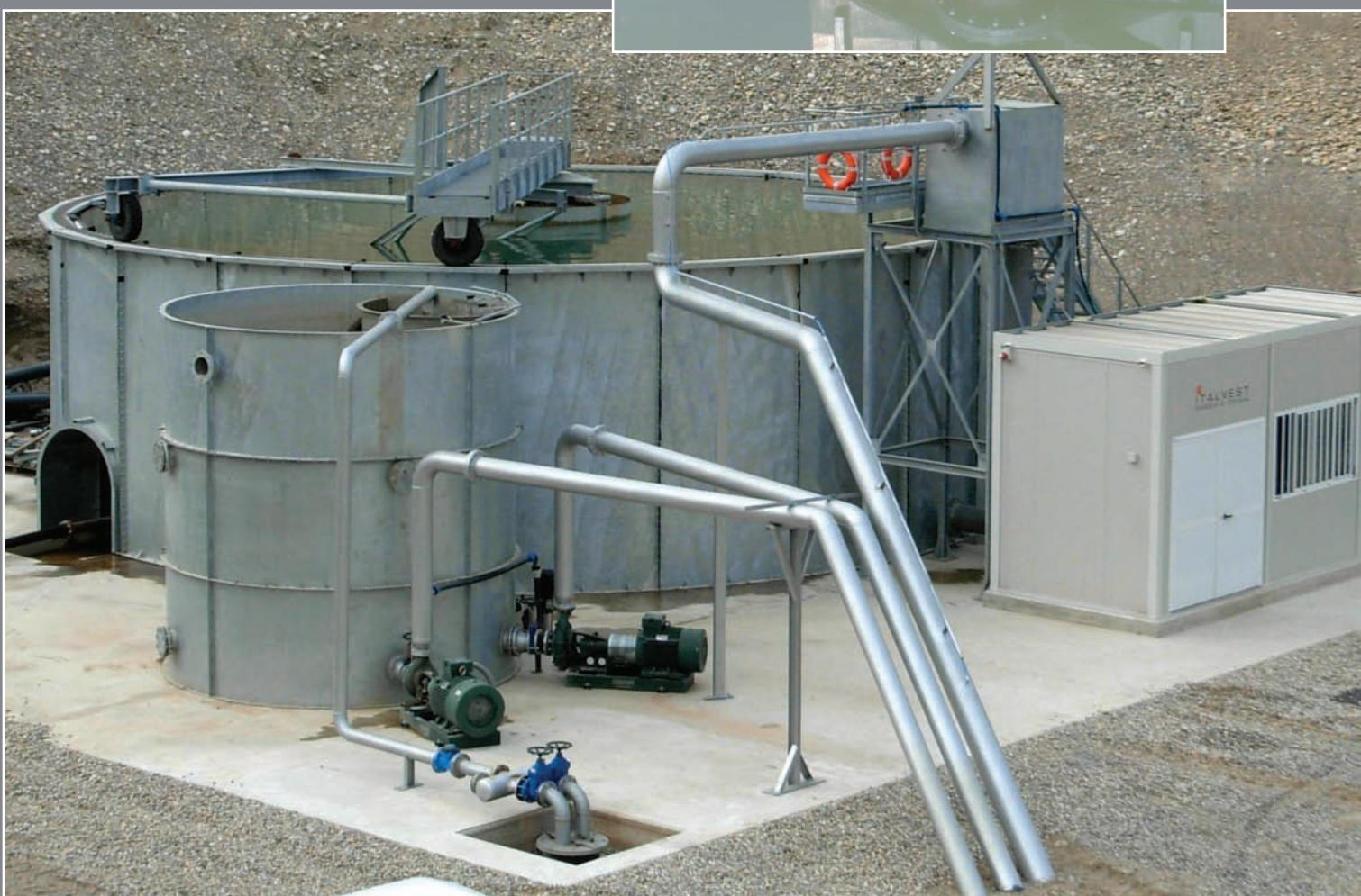
**Il chiarificatore radiale serie CPR** è progettato per funzionare automaticamente sia sul processo di chiariflocculazione che ispessimento dei fanghi in estrazione dalla macchina stessa.
